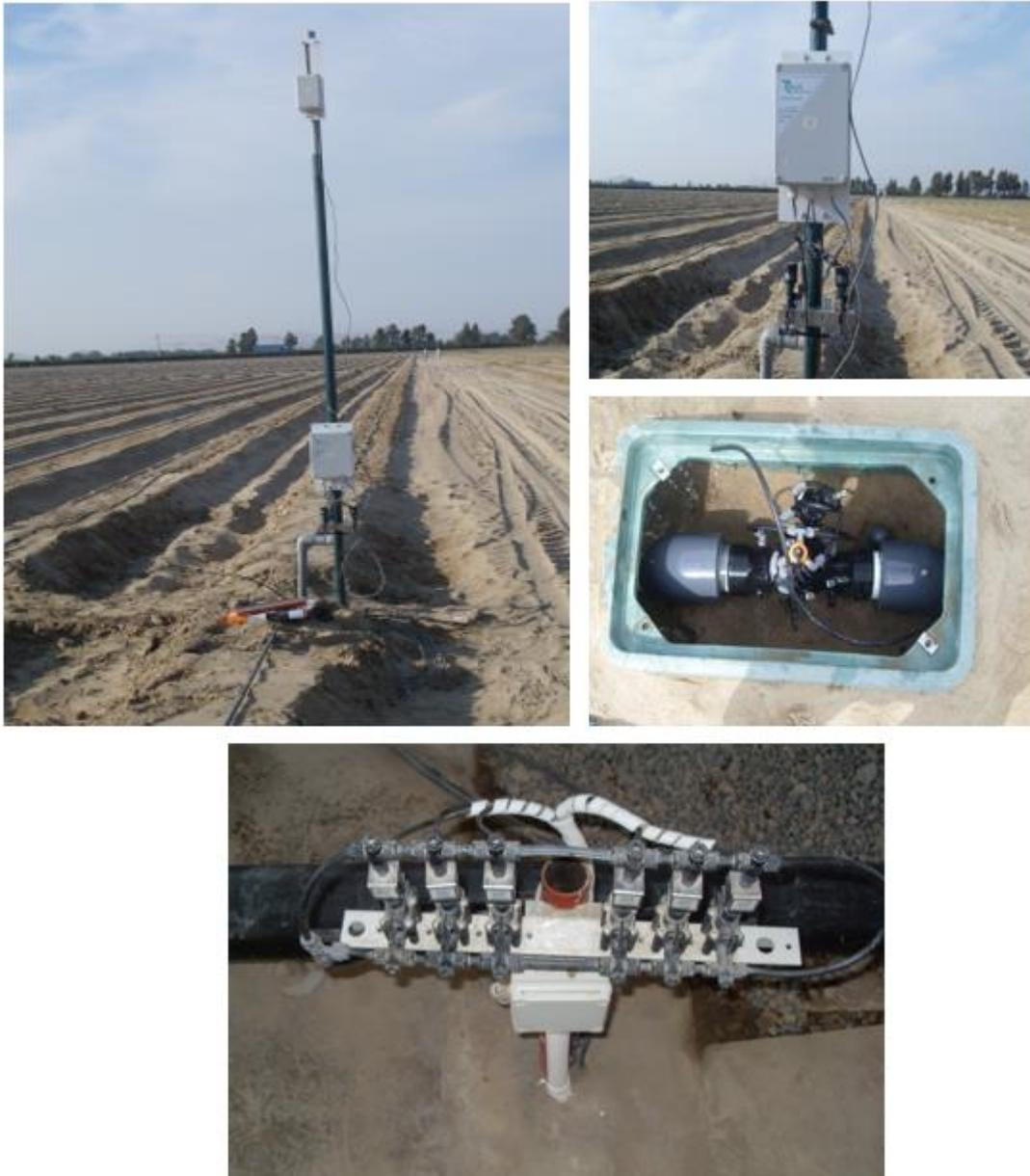
Fig. 12. Módulos de campo para radiocontrol de las válvulas hidráulicas de riego.
